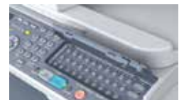
Teclado QWERTY completo (en los modelos MB491+LP) detrás del panel de teclas de tacto
